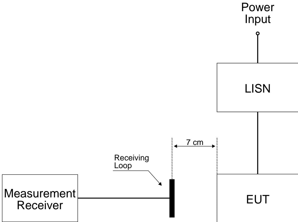
**FIGURE RE101-4. Basic test setup.**
