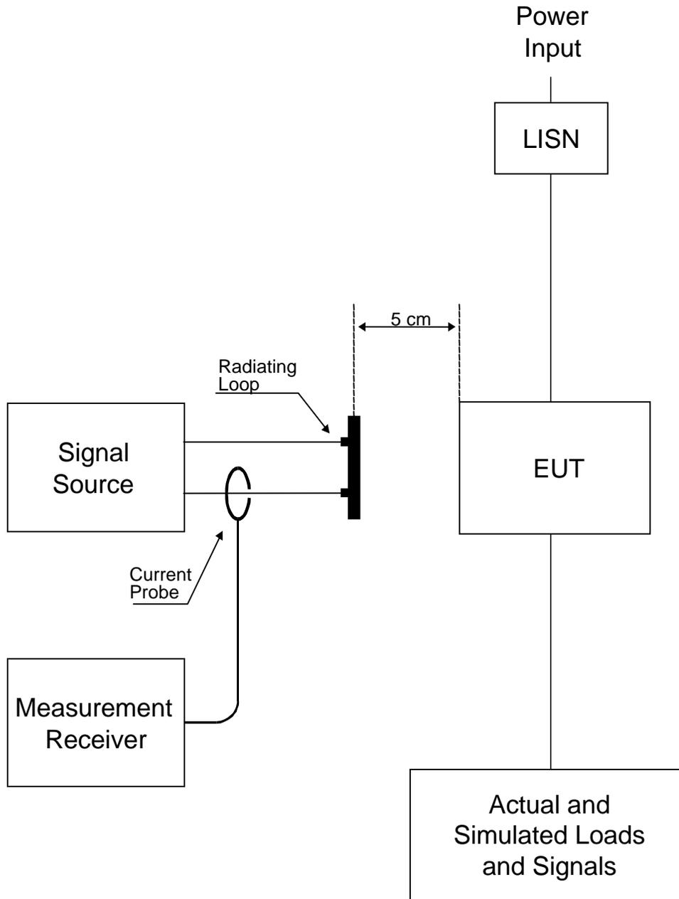
**FIGURE RS101-4. Basic test setup**
