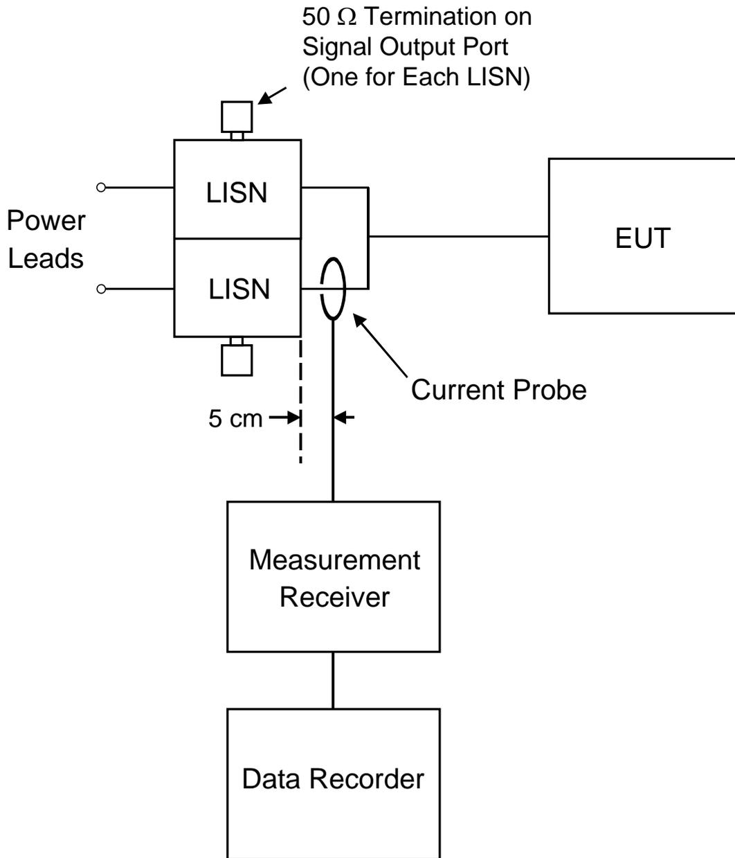
**FIGURE CE101-6. Measurement setup.**
