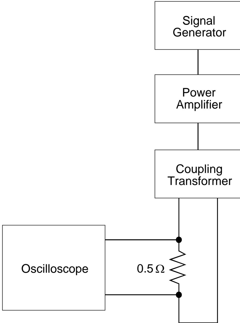
**FIGURE CS101-3. Calibration.**
